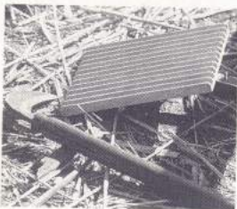
ロジャーさん愛用の道具たち。下の四角いコテのようなものが、前ページでも紹介した葺の端を揃えるための道具。
